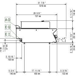
Electrical inlet (power) EQ **Equipotential screw**
